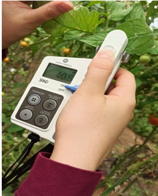
Şekil 4. Yapraklardaki SPAD metre okuması ile Klorofil Miktarının Tahmin edilmesi
