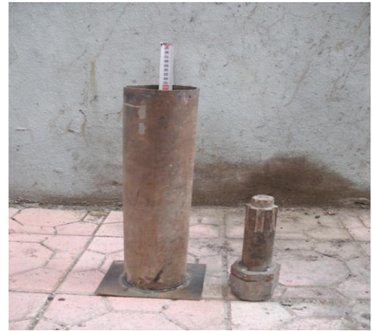
Şekil 4. Modifiye darbe shatter dayanımı test düzeneği fotoğrafı
